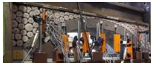
写真 3 壁石を含む載荷実験の様子
