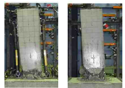
写真-2 橋脚の損傷状態
