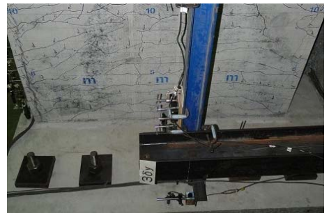
写真-3 3δ₀終了時の柱基部 (m面)
