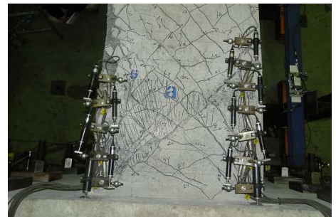
写真-2 3δ₀終了時の損傷 (a面)
