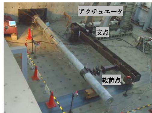
写真-1 正負交番載荷試験の状況
