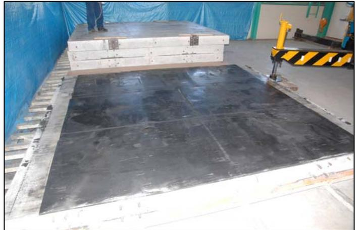
図4 摩擦実験状況
