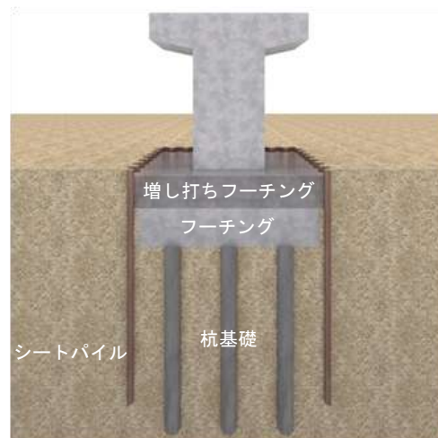
図1 既設杭基礎のシートパイル補強工法の概要
