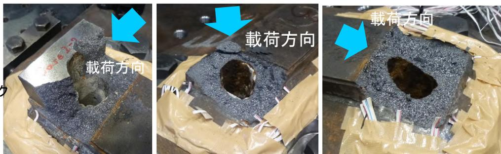
図 3 線支承の破断状況 (左: SB-O-0, 中: SB-O-45, 右: SB-O-90)
