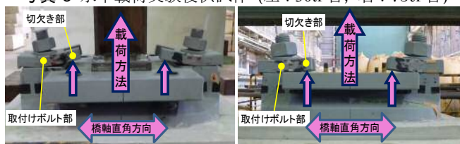
写真-4 鉛直載荷実験後供試体 (左: 30tf 沓, 右: 75tf 沓)
