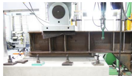
写真-1 線支承載荷状況
