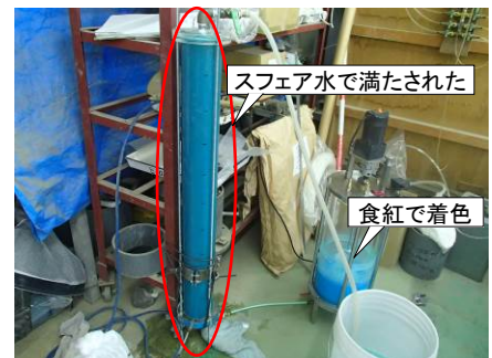
写真-1 注入性検証実験
