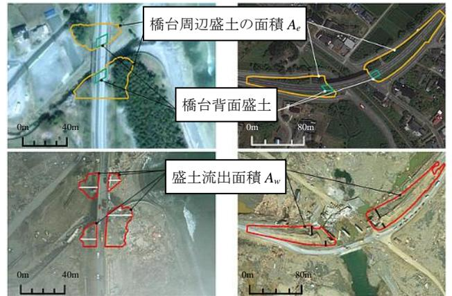
図 3 衛星画像での被害把握(上:被災前, 下:被災後)
