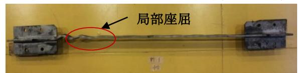
写真 2 ブレース芯材の破壊状況
