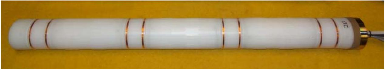
図2 FE試験で開発したTDRゾンデ. 各孔につき30 cm間隔で4計測点とした.
