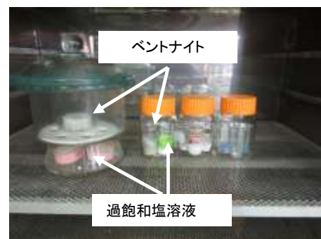
写真-1 蒸気圧法による湿度制御
