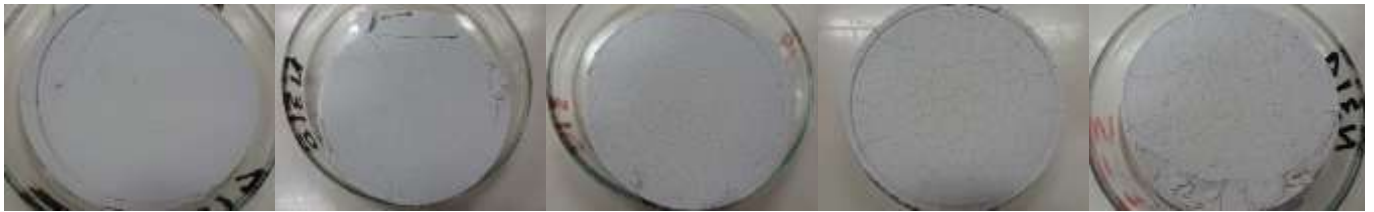
写真-2 測定開始から188日の供試体上面の様子 (左から20℃、30℃、40℃、50℃、60℃)
