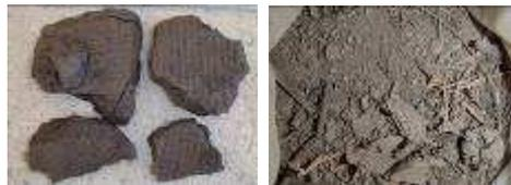
写真-3 脱水ケーキ 写真-4 沈砂槽残渣
