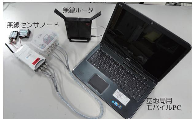
図-1 無線加速度センサシステムの構成
