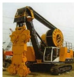
図10 低空頭の地盤改良機械
