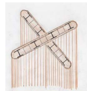
図6 地盤改良壁基礎の概念
