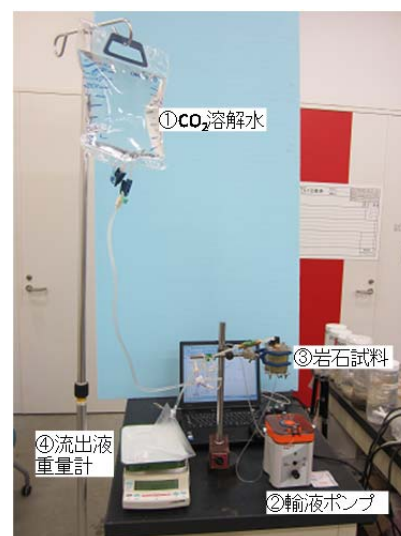
写真-2 通水試験装置全景
