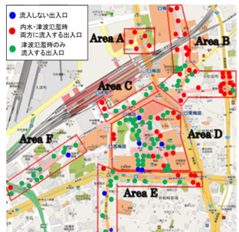
図-4 流入した地下出入口
