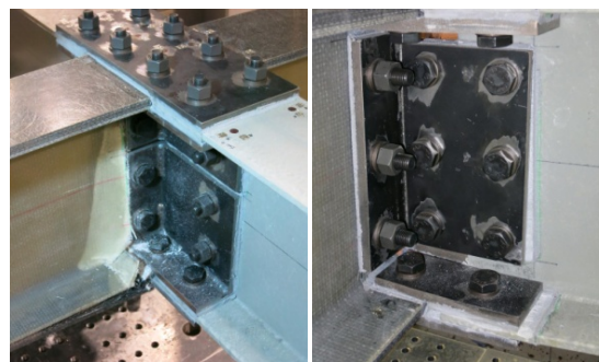
(a) 曲げ圧縮破壊 (Type I) (b) せん断破壊 (Type II)
