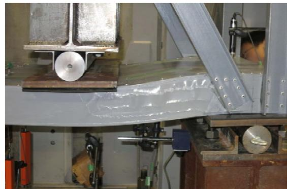
図-5 床版部のせん断破壊の様子
