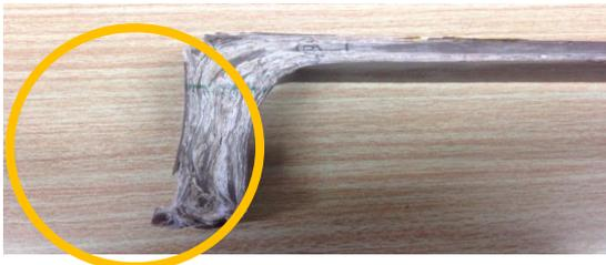
写真-5 試験体のつぶれ
