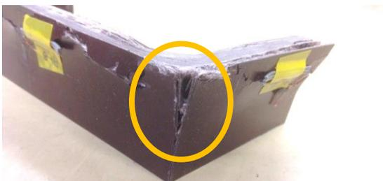
写真-6 試験体の角部の稜線分離
