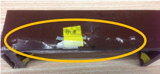
写真-3 試験体の座屈
