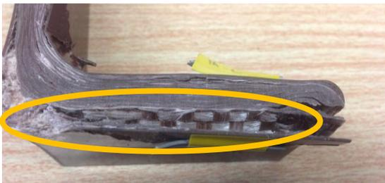
写真-4 試験体の剥離
