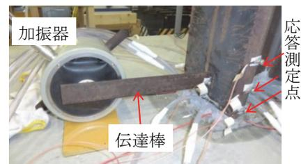
写真 - 1 柱基部の振動試験状況
