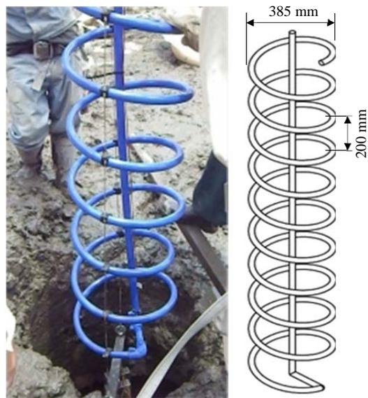
図 1 スパイラル型熱交換器
