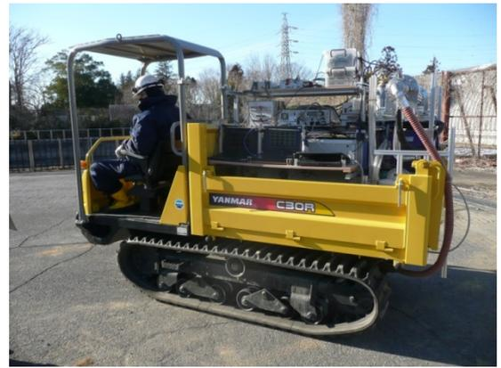
図-1 車載型排出ガス測定装置搭載状況
