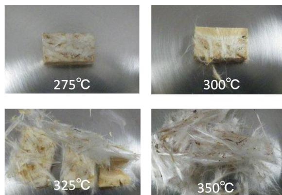
図-5 溶解試験後の SMC 成形樹脂乾燥状況
