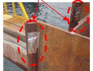
図4 継手部温度計測
