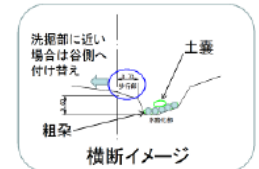
図-5 登山道の山側への振り替え(H24年施工区間の例)
