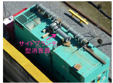
図1 サイドブランチ型消音器の減音原理
