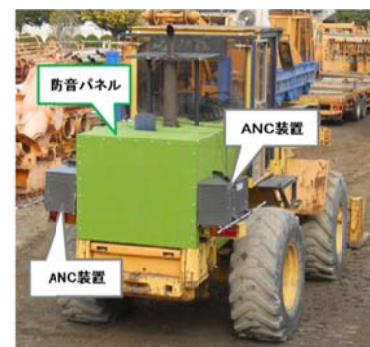
写真-1 騒音対策の状況
