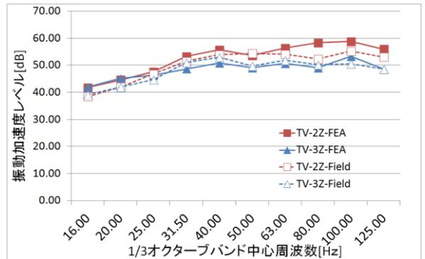
図5 解析結果と測定結果との比較 (構築)
