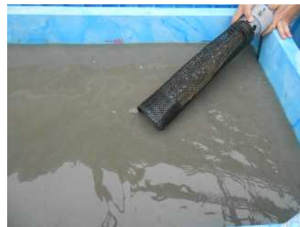
写真-2 膜ろ過ユニットの状況
