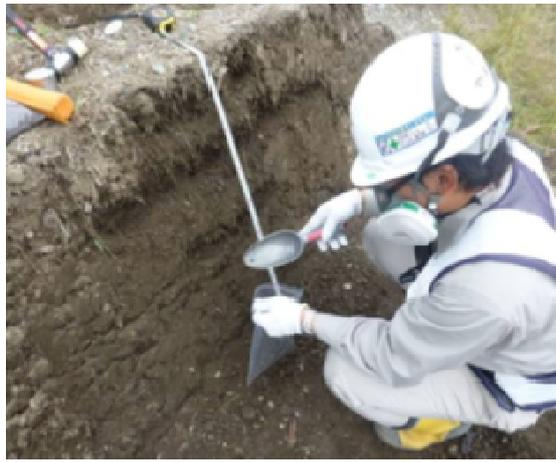
図-3 木質混合土サンプリング状況
