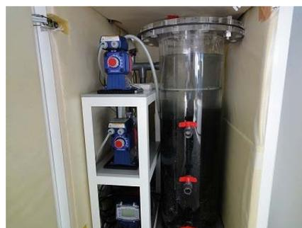
写真-1 USB 型脱窒槽
