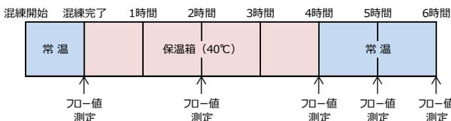
図-3 配合試験タイムテーブル
