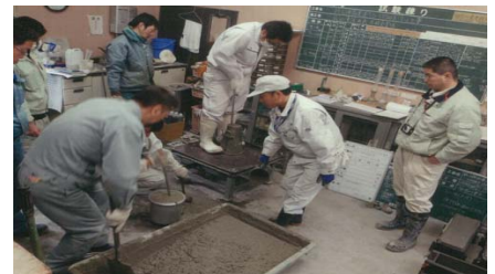
試し練り試験の状況
