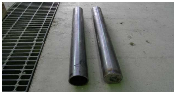
写真2 杭模型(左:開管, 右:閉管)
