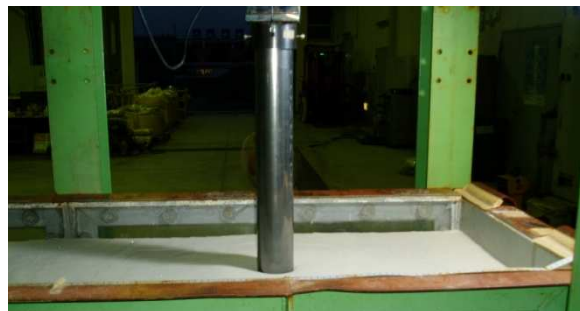
写真3 杭の貫入状況
