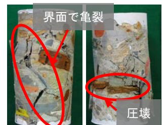
供試体 A 供試体 B 写真-3 破壊状況の代表例
