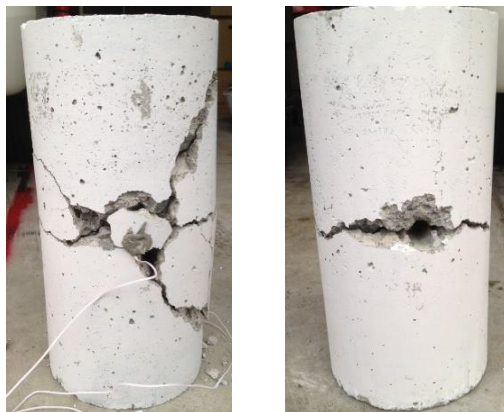
(a) 装薬径 \phi 15 (b) 装薬径 \phi 20
