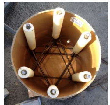
写真2 型枠内の鉄筋配置
