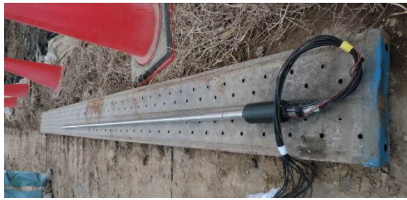
写真-1 モニタリング鉄筋の概要
