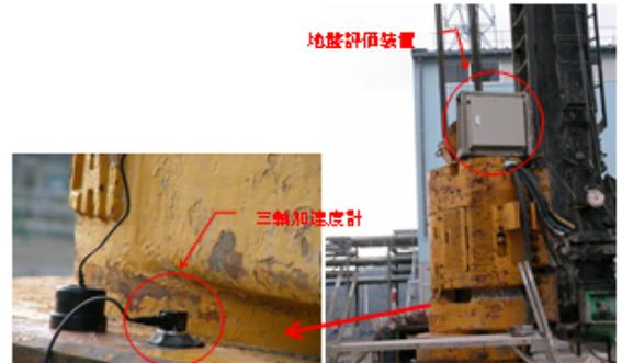
写真-1 地盤評価装置・センサ取付け状況
