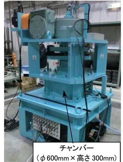
写真-1 実験装置全景
