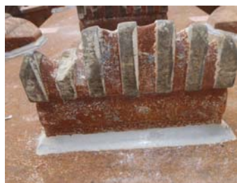
写真-4 強化先行ビット摩耗状況
