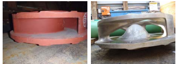
写真-2 排泥ポンプインペラ摩耗状況
