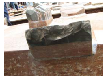
写真-5 ティースビット摩耗状況
