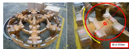
図-5 カッタビット摩耗状況
