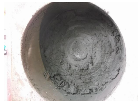
図-4 掘削後の模擬地盤
