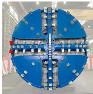
図-7. シールド機正面
