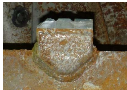
図-1. 礫によってチップが欠ける
