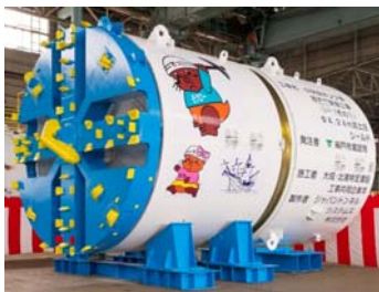
図-4. シールド機全景
