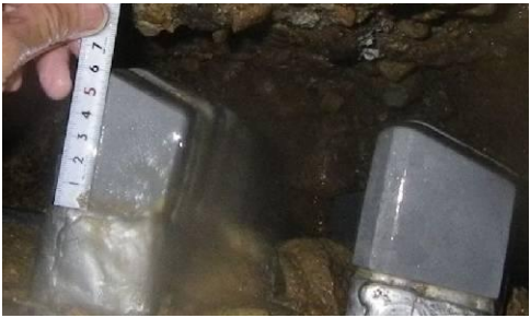
写真－3 ビット計測状況(1600m地点)
