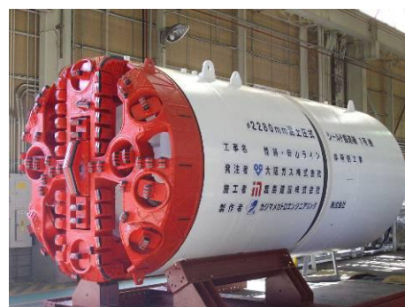
写真－1 先行ビット仕様シールド機
