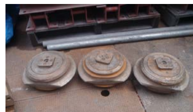
写真-3 偏摩耗したローラーカッター
