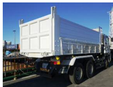
写真-3 土砂搬出ダンプ(改造型)
