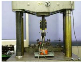
写真-1 押込み試験
